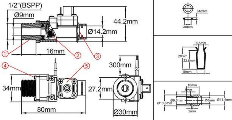
**1:** Wassereinlassgewinde    **2:** Durchfluss-Erkennungsklappe
