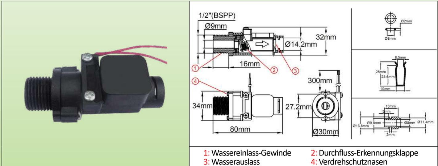
**Hauptanwendungen:** Das Produkt wurde für Miniatur-Durchlauferhitzer für Duschen entwickelt. Das bewegliche Klappensystem sorgt für Kompaktheit. Der Wasserzulauf erfolgt direkt über das 1/2" BSPF-Außengewinde. Vertikale Montage vorgeschrieben, mit Wasserzulauf von unten. Anschluss an interne Kupferrohrleitungen DN8 und DN10 mit Schnellkupplung.
