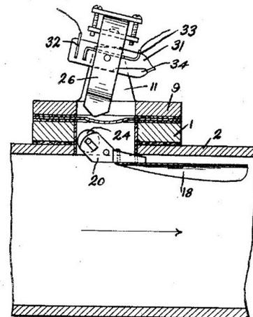
1931 erfindet Louis E. Richmond den ersten Paddelschalter mit magnetischer Betätigung (US-Patent 1888737). Ein Paddel mit einer Metallrolle betätigt einen ausgeglichenen Magneten mit einem außen liegenden Quecksilberschalter.
