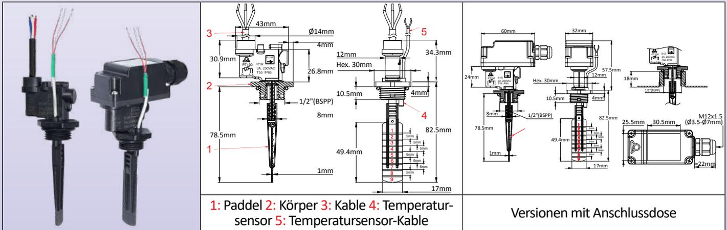
**Hauptanwendungen:** Erkennung des Wasserdurchflusses in Wasserrohren, mit gleichzeitiger Messung der Wassertemperatur
