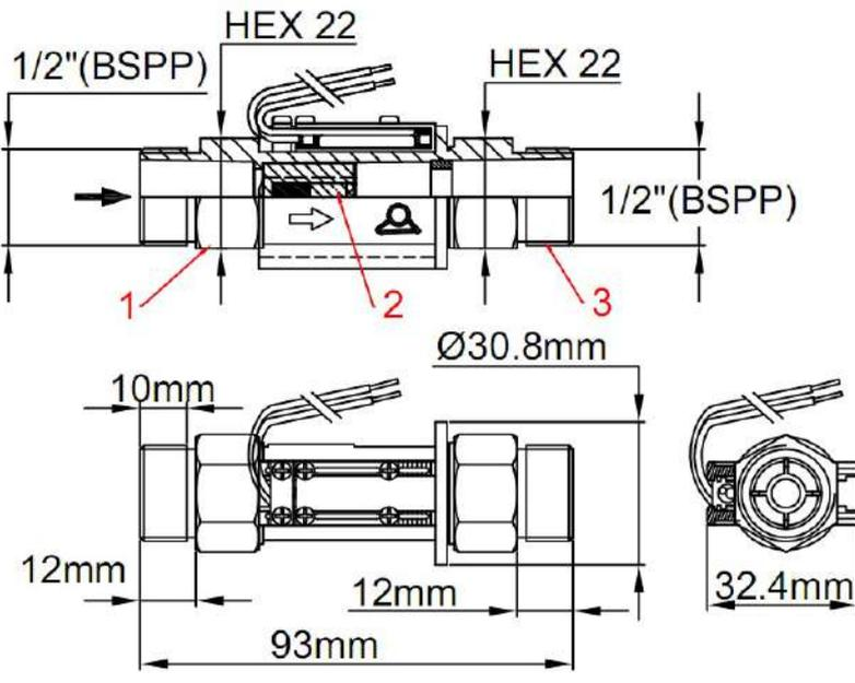
1: 1/2" BSPP-Wassereinlass      2: Kolben zur Durchflusserkennung
