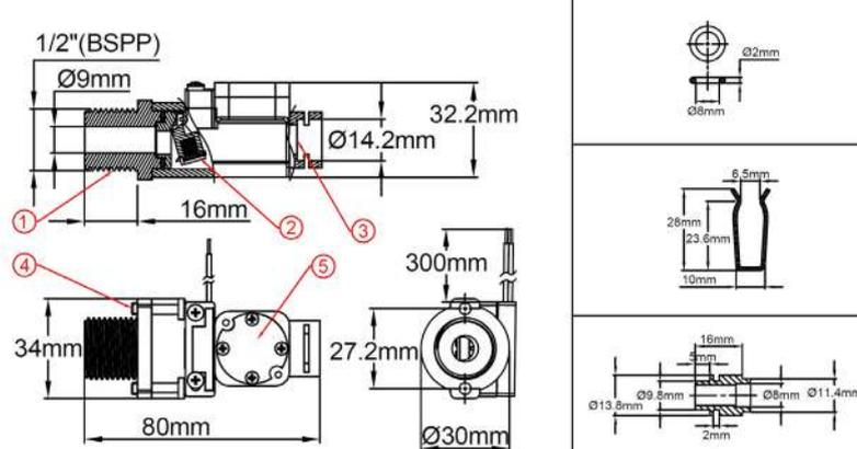
1: Wassereinlassgewinde    2: Durchfluss-Erkennungsklappe
