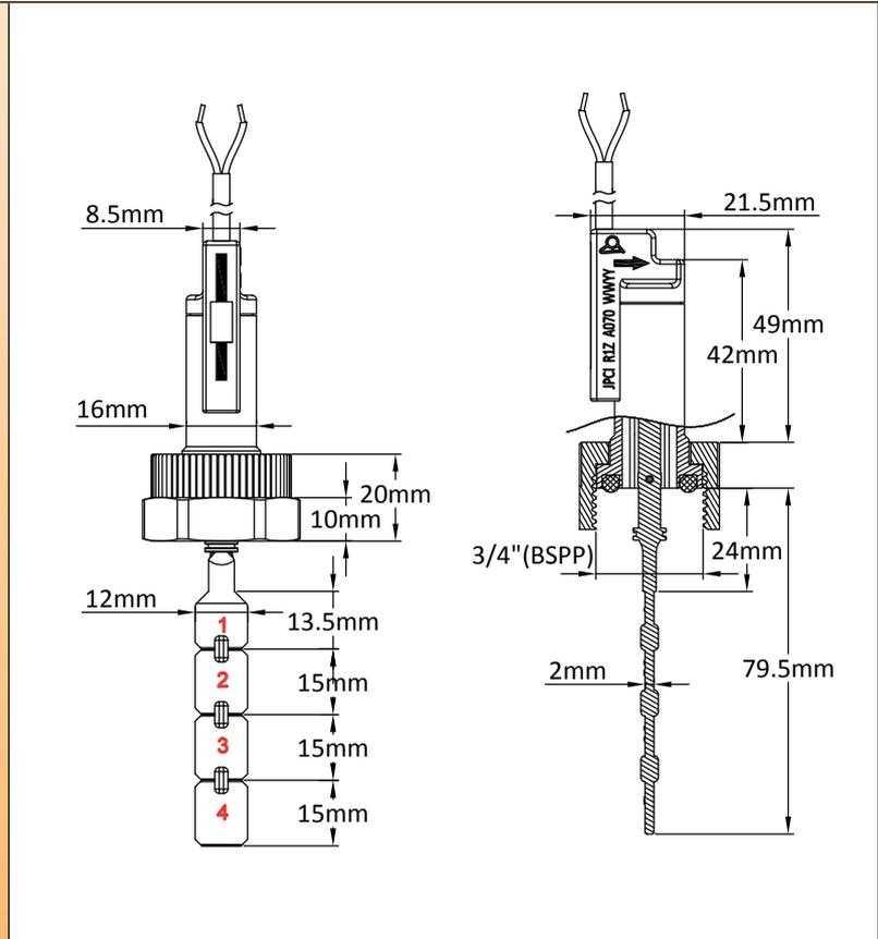
**Hauptanwendungen:** Sehr verbreitete Anwendungen bei der Durchflusserkennung mittels elektronischer Niederspannungsschaltungen. Die wirtschaftlichste Form. Empfohlene Montage-Position ist auf horizontalen Rohren. Kann in jeder Position mit geringer Abweichung in der Kalibrierung wegen des Paddelgewichts montiert werden. Kann an Wasserrohren mit  $\varnothing 15 - 100\text{mm}$  verwendet werden.
