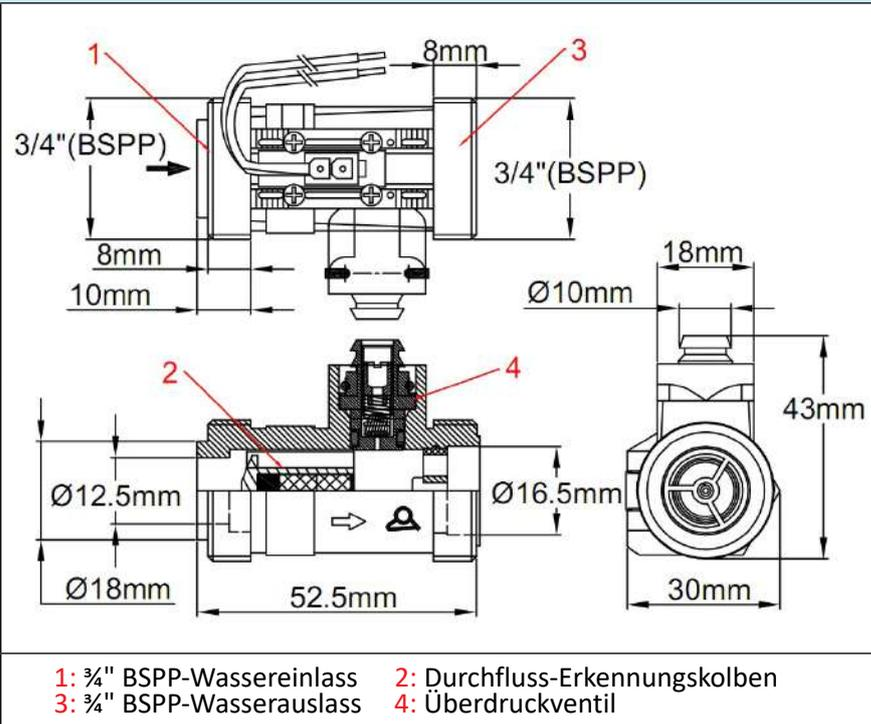
**Hauptanwendungen:** Das Produkt wurde für elektrische oder gasbetriebene Durchlauferhitzer entwickelt. Wassereinlass und -auslass mit  $\frac{3}{4}$ " BSPP-Außengewinde. Vertikale Montage vorgeschrieben, mit Wassereinlass von unten. **Integriertes Überdruckventil.**
