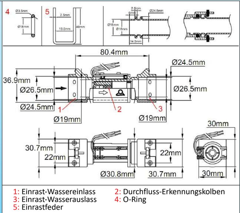
**Hauptanwendungen:** Das Produkt wurde für elektrische oder gasbetriebene Durchlauferhitzer entwickelt. Einrast-Wassereinlass und -Wasserauslass für Kupferrohre. Vertikale Montage vorgeschrieben, mit Wassereinlass von unten.
